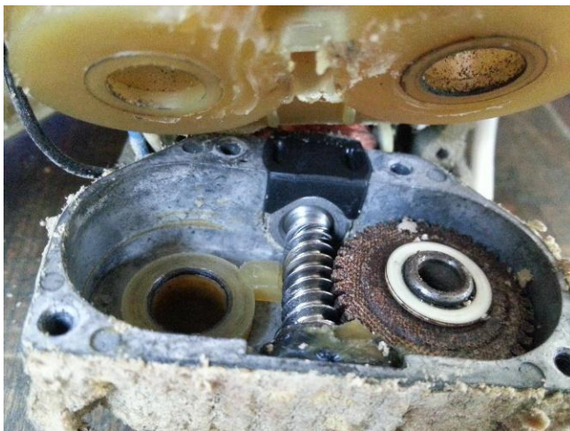
Abbildung 10: Getriebe älterer Bauart mit Gehäuse
