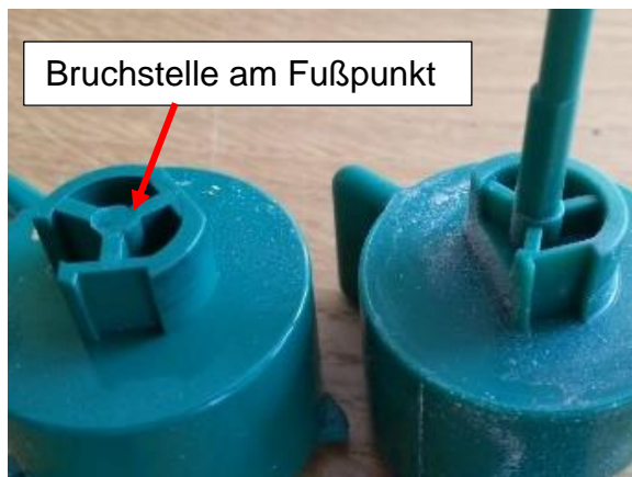
Abbildung 6: Vergleich defekter/intakter Schalter
